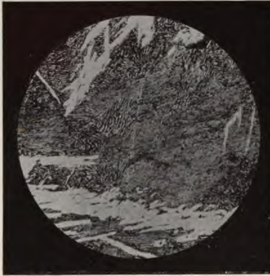
Fig. 138. Werkzeugstahl (ausgeglüht). Heller Cementit, in Perlit eingebettet.
